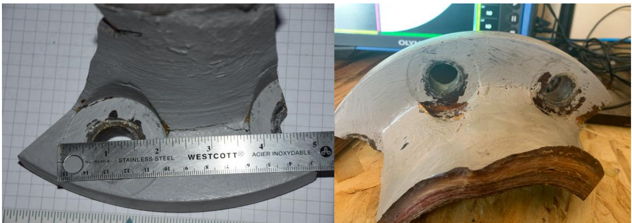
Obrázek 2. Trhlina mezi otvory šroubů ve vzorku, který je odříznutý z FRP příruby
