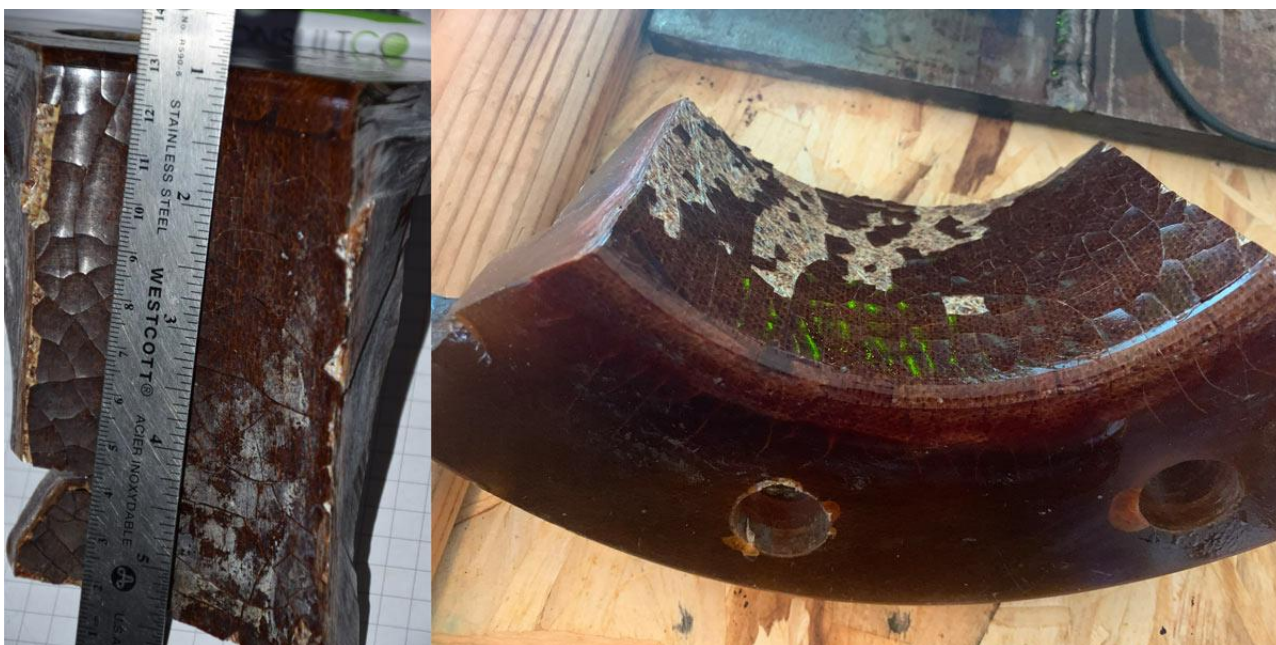
Obrázek 4. Stav vnitřního povrchu a koroze FRP
